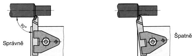
Soustružnický nůž upnutý pod pravým úhlem k ose soustružení
