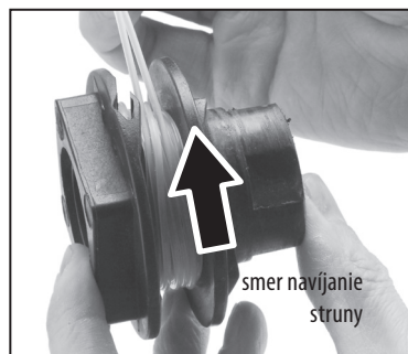
Obr.10, navíjanie struny na cievku
