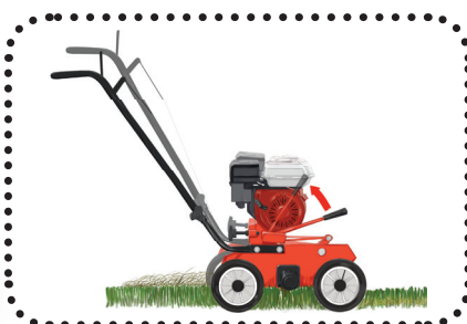
Výšku provzdušňování lze nastavit pohodlně samostatnou seřizovací pákou.
