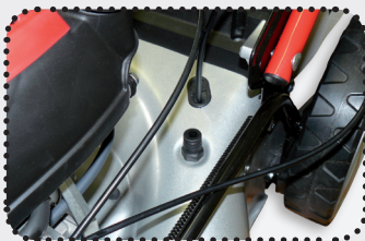
adaptér pro mytí podvozku sekačky
