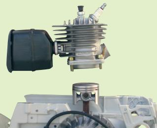
Postříbřená jehlová ložiska jsou použita do klikové hřídele ke snížení pracovní teploty. Píst, válec a pístní kroužky jsou vyrobeny ze speciálního materiálu pro zajištění dlouhé životnosti motoru.
