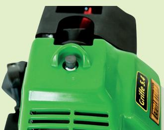
Dekompresní ventil slouží pro lepší startování. Použit většinou u modelů s větším obsahem motoru.
