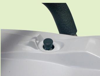
Některé modely jsou vybaveny dekompresním ventilem, který zajišťuje snadný start. Dále zajišťuje dlouhou životnost startovacích komponentů.
