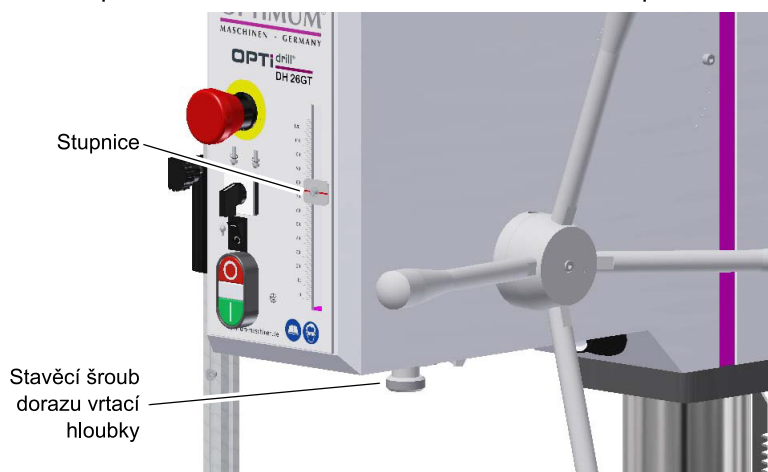
Obr. 4-6: Doraz vrtací hloubky
