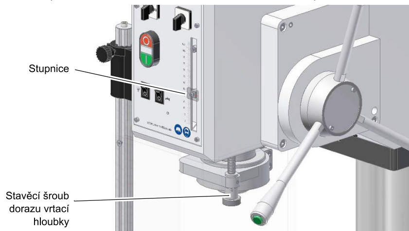
Obr. 4-16: Doraz vrtací hloubky
