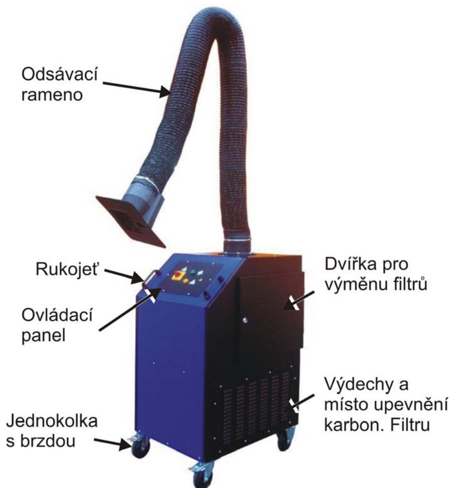
Obrázek 1 - Hlavní části stroje
