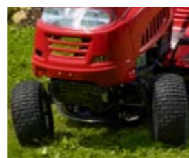
Výkyvná přední náprava zajišťuje rovnoměrné a profesionální sečení i na nerovném terénu.
