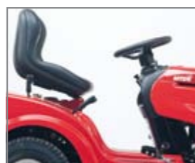
Volně průchozí rám bez středového tunelu usnadňuje nastupování a vystupování, které je díky tomu velmi pohodlné.
