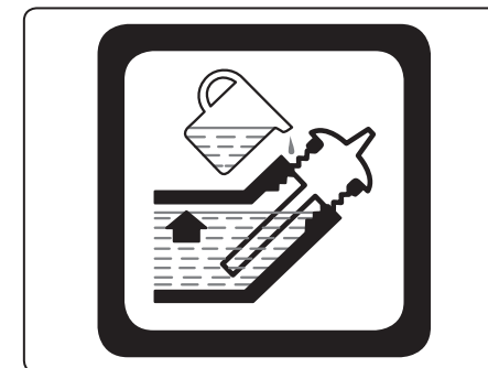
5. ábra: Az olajszint ellenőrzése
