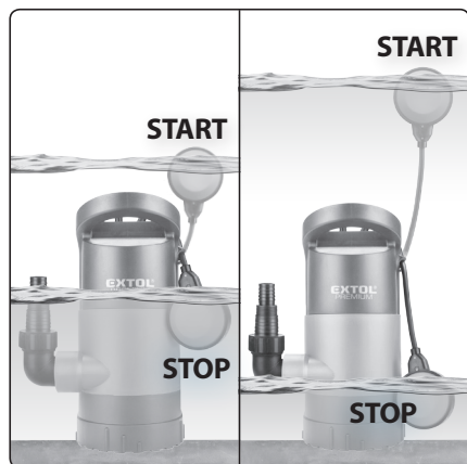
Obr.4, ilustrace funkce plovákového spínače
