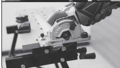
Obr. 20, rezanie hliníkovej rúrky a rohovej lišty
