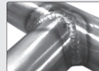
Obr. 6. Spojenie antikorových rúrok metódou TIG
