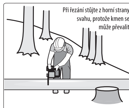
Kmen podepřen na obou koncích, obr. 19
