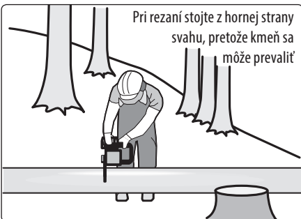
Kmeň podporený na oboch koncoch, obr. 19
